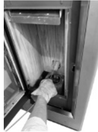
Fig. 36 - Reiniging met flessenwisser
