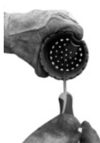
Fig. 34 - het schoonmaken van de vuurpot
